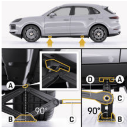
рис. 275: Установлення бортового домкрата
