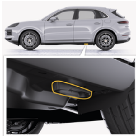
рис. 274: Точка опори для підйомника й домкрата ззаду
