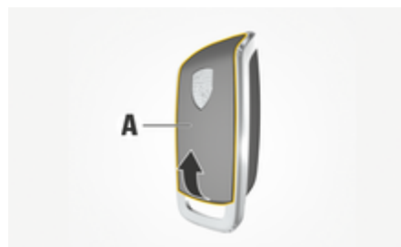
рис. 84: Заміна елемента живлення
