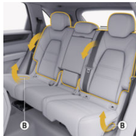
рис. 69: Складання спинок крайніх задніх сидінь
