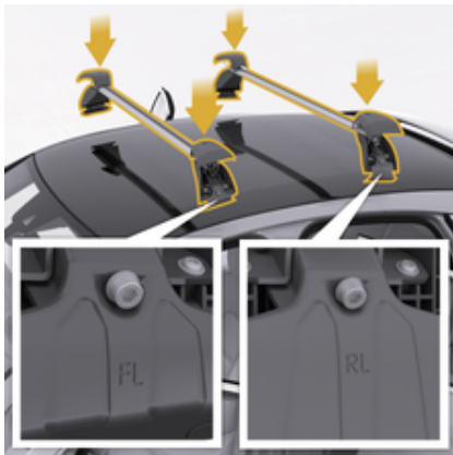
рис. 193: Установлення траверс на дах
