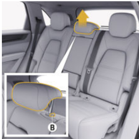
рис. 74: Знімання підголовника середнього заднього сидіння
