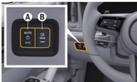
рис. 113: Панель керування освітлювальними приладами
