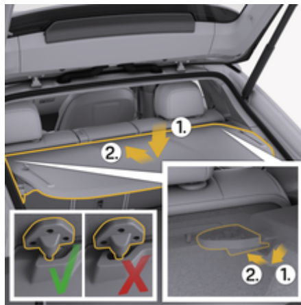
рис. 215: Уставляння полиці багажного відсіку
