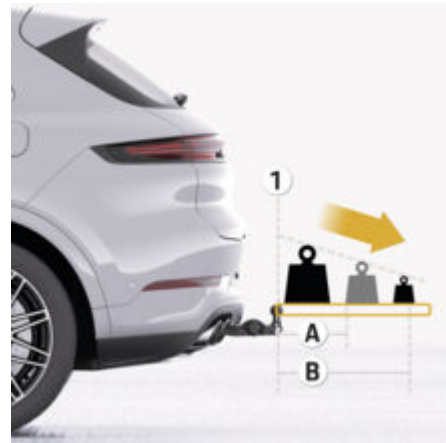
рис. 188: Принципова схема розподілення навантаження монтажних деталей і приладдя
