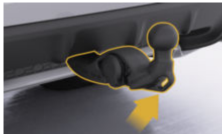
рис. 187: Кріплення страхувального троса причепа за спеціальне вушко
