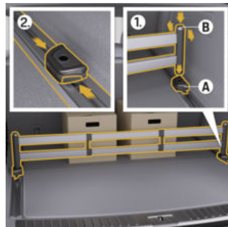
рис. 219: Встановлення телескопічної штанги
