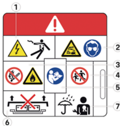
рис. 2: Попереджувальне маркування на високовольтному акумуляторі
